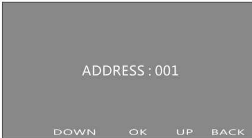
1. Durch Drücken der Taste
