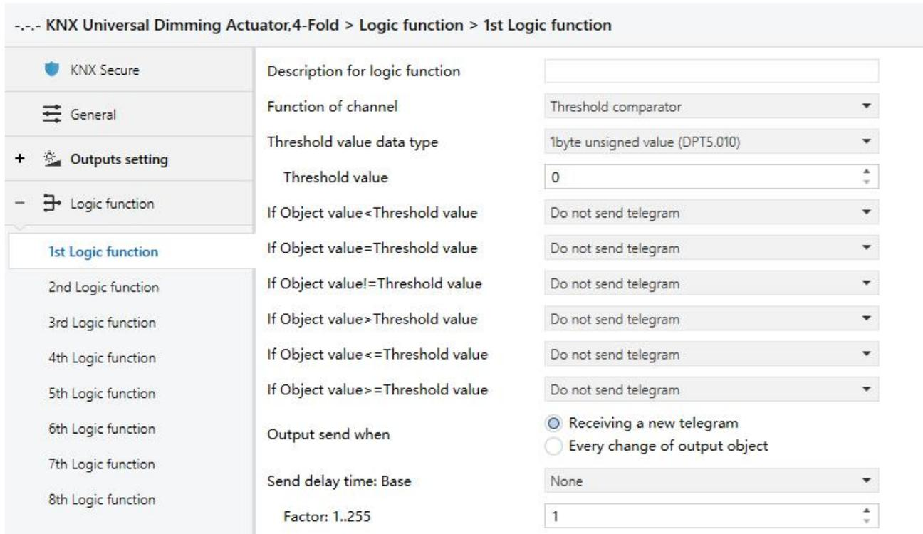
Fig.5.4.3 "Threshold comparator" parameter window
